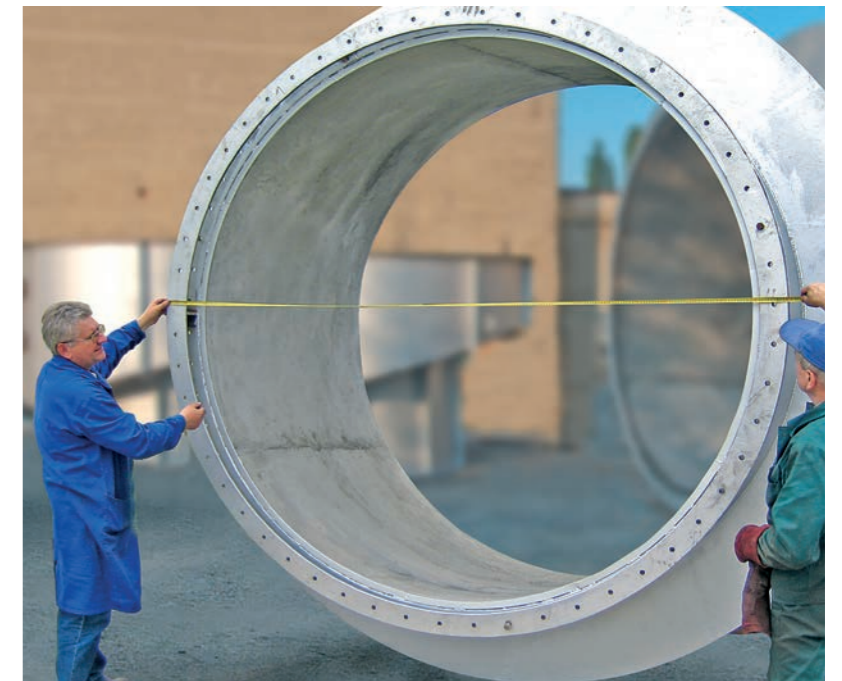
Футеровка трубчатой детали в установке для размола цемента с помощью материала KALCRET BNХ, диаметр до 3200 мм
