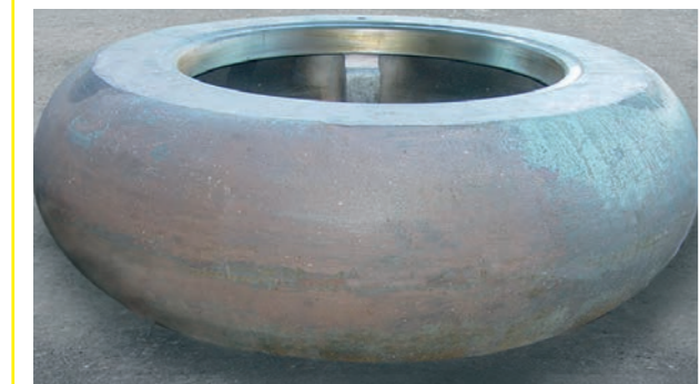
Для систем размола сырья, угля и клинкера компания Kalenborn поставляет также измельчающие валки, размольные столы и футеровку для мельниц. Вверху показан восстановленный с помощью материала KALMETALL W100 измельчающий валок, внизу – новая деталь, отлитая из отбеленного чугуна KALCAST C155 (диаметр каждого изделия 1500 мм).
