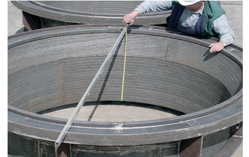
Отдельные конусы в сепараторах для цемента, выполненные из материала KALMETALL W100 6 + 4, диаметр 3000 мм
