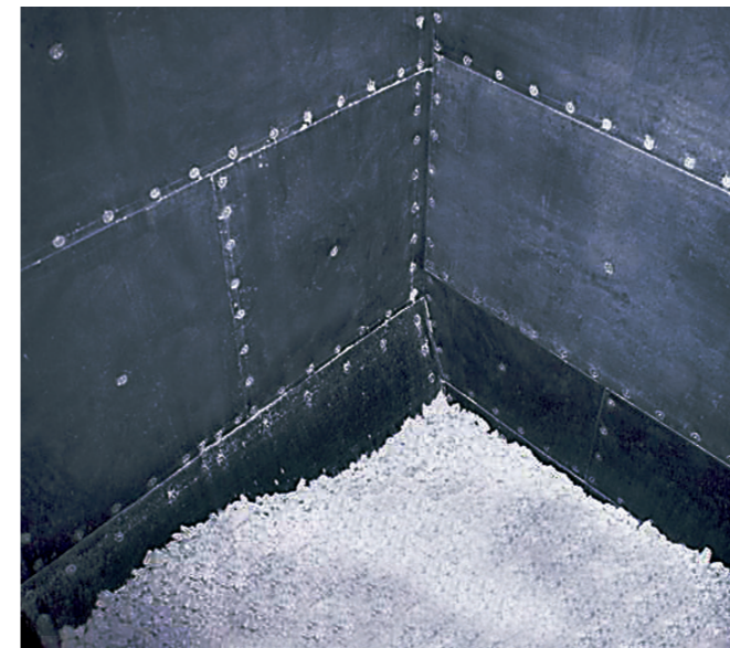
Защита мельницы для производства сырьевой муки: материал KALCRET используется в системе труб, KALMETALL W100 применяется в качестве материала для футеровки мельницы.
