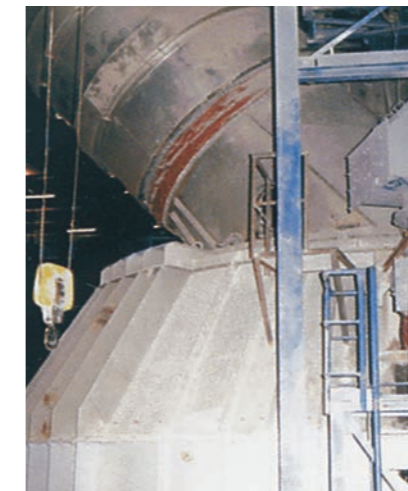
Защита мельницы для производства сырьевой муки: материал KALCRET используется в системе труб, KALMETALL W100 применяется в качестве материала для футеровки мельницы.
