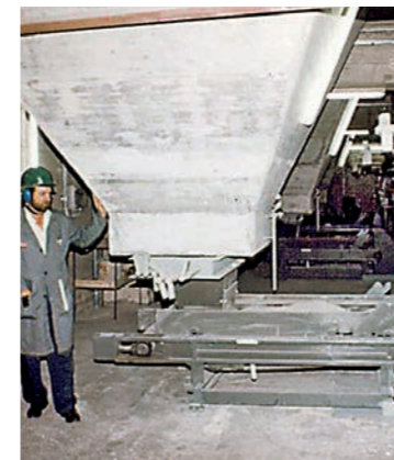
Бункер для сырьевой муки покрыт антиадгезионной футеровкой на основе KALEN 1006.
