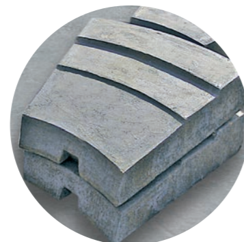
Сегменты размольного стола вертикальной роликовой мельницы диаметром 5000 мм выполнены из материала KALCAST; детали меньшего размера изготавливаются методом литейного формования.
