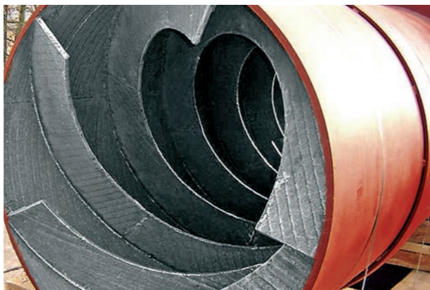
Подающий шнек для входного цилиндра мельницы, защищенный материалом KALMETALL W100, диаметр 1350 мм, толщина футеровки 5 или 8 мм, самонесущая конструкция.
