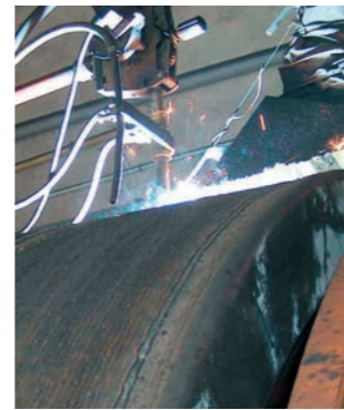
Сервисное обслуживание компании Kalenborn: восстановление измельчающего вала с использованием материала KALMETALL W100
