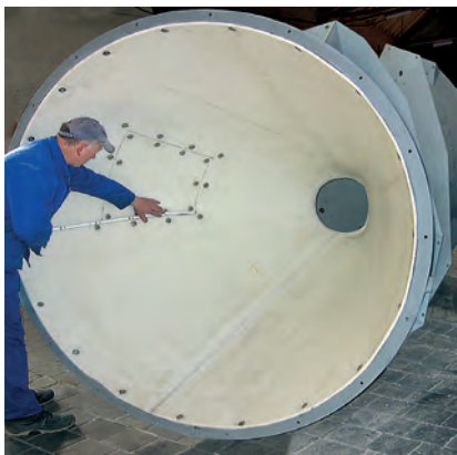
Антиадгезионная футеровка разгрузочной воронки силоса из пластика повышенного скольжения ULTRAGLIDE.
