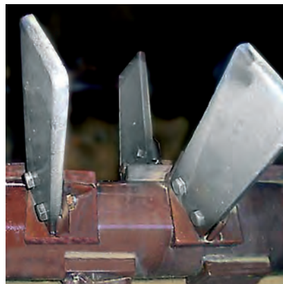
Ножи из KALMETALL-C 153 для промывки минералов.
