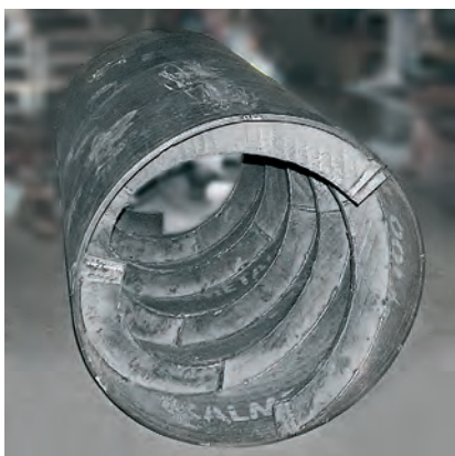
Лопатки шнека на входе в дробилку с обеих сторон усилены с помощью ULTRAPLATE, диаметр 800 мм.
