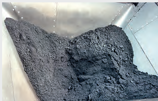
Гладкая футеровка предотвращает проблемы, связанные с налипанием и забиванием, при выгрузке сырья из силосов и бункеров.
