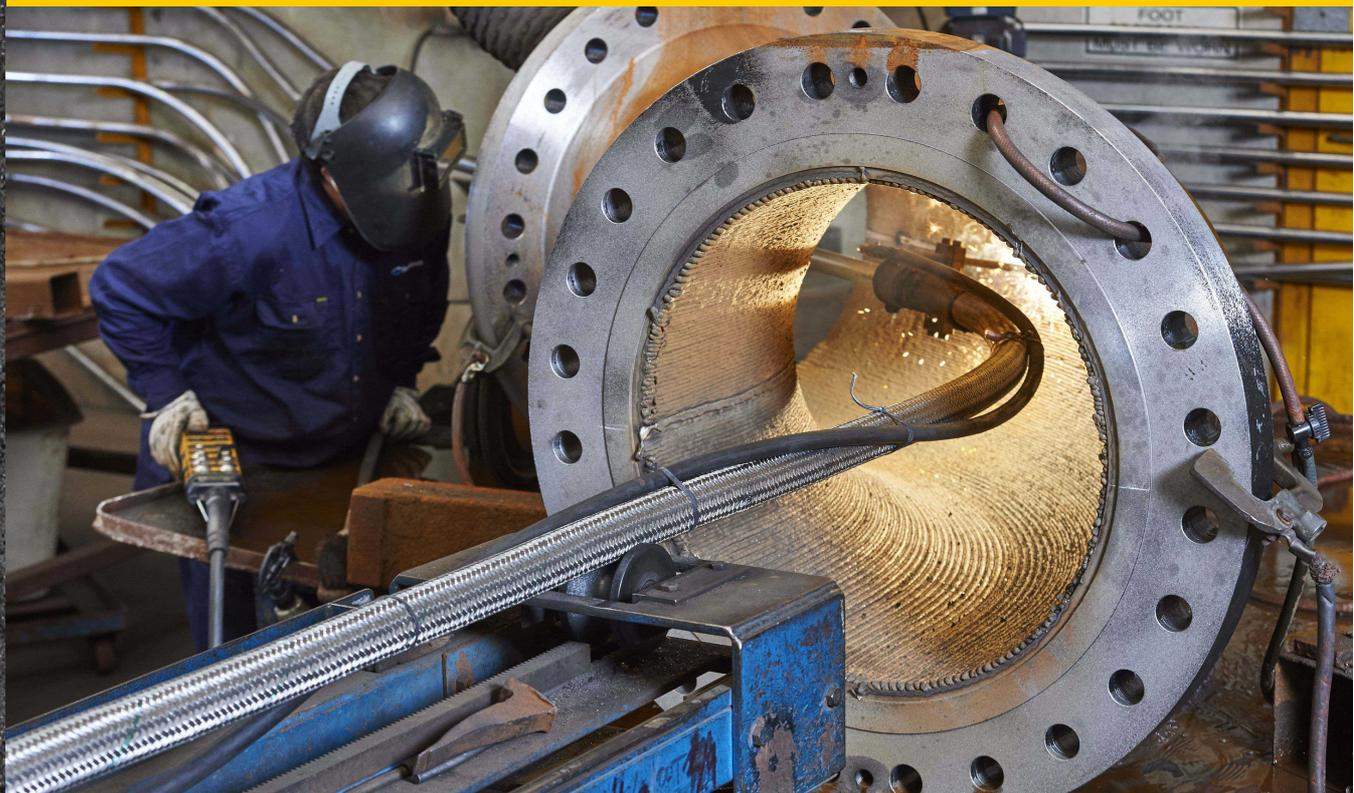
БИМЕТАЛЛИЧЕСКАЯ ТРУБА ТЕСНPIРЕ® ЭТО ЛУЧШЕЕ РЕШЕНИЕМ ОБЛАСТИ ЗАЩИТЫ ОТ ИЗНОСА УЧАСТКОВ ТРУБО И ПУЛЬПОПРОВОДОВ, РАБОТАЮЩИХ В УСЛОВИЯХ ИНТЕНСИВНОГО АБРАЗИВНОГО ИЗНОСА.
