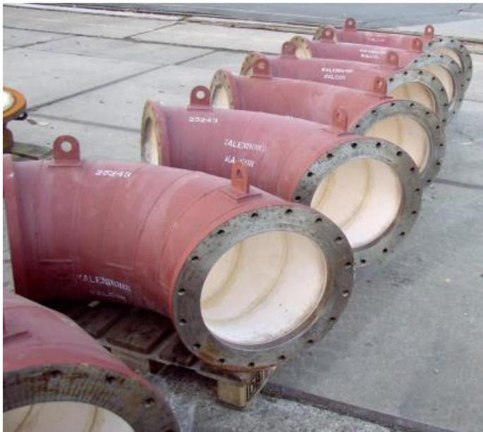
Отводы для подачи пылеугольного топлива
